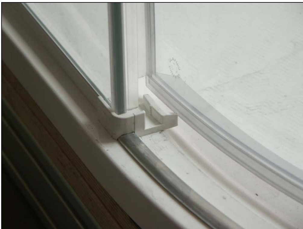
Náraz z vnější strany, posuvný díl – stav po zkoušce: sklo vyraženo z posuvného dílu (možno nasadit zpět jako při čištění).
