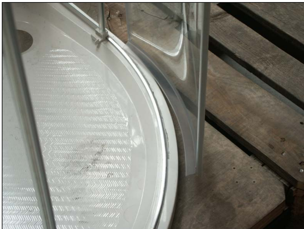
Náraz z vnitřní strany, posuvný díl – stav po zkoušce: posuvné sklo vyraženo z vodicího dílu (možno nasadit zpět jako při čištění).
