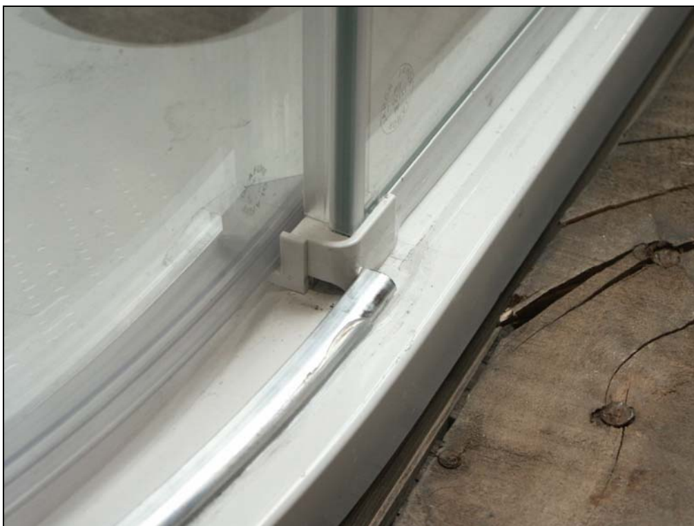
Náraz z vnější strany, pevný díl – stav po zkoušce: plastová koncovka vytažena přes prahovou lištu (možno nasadit zpět).
