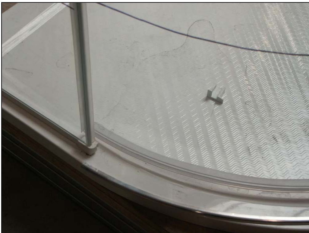
Náraz z vnější strany, pevný díl – stav po zkoušce: vodící díl vysunut (možno nasadit zpět jako při čištění).
