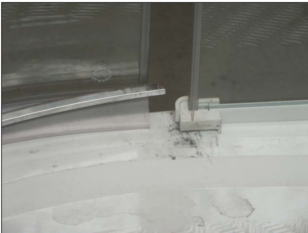
Náraz z vnitřní strany, posuvný díl – stav po zkoušce: posuvné sklo vyraženo z vodicího dílu, vodicí díl vysunut (možno nasadit zpět jako při čištění).
